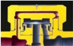
一般のディスクトラップは一重蓋か二重蓋の空気保温式を採用しています。一重蓋の外気冷却式では、外気の影響を受けやすく、ドレンがなくても作動し、空打ち、吹放しといった蒸気ロスが発生しました。
