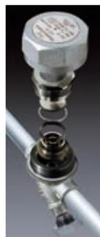
ディスクトラップは、その作動原理・構造上、要部の摩耗が激しく寿命が短いのが欠点です。A3Nは、その摩耗し易い部品(弁座、ディスク弁、内蓋など)をユニットとして交換可能にしているため、配管からの脱着を必要とする製品交換に比べ、交換時間も短くメンテナンスコストを抑えることができます。
