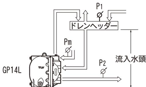
1. 排水能力グラフを使用し、操作気体の種類、操作気体圧力 (Pm)、背圧 (P2) より圧送流量を求め、
